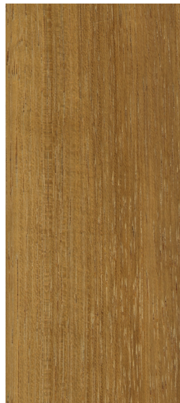
Débit sur faux quartier
